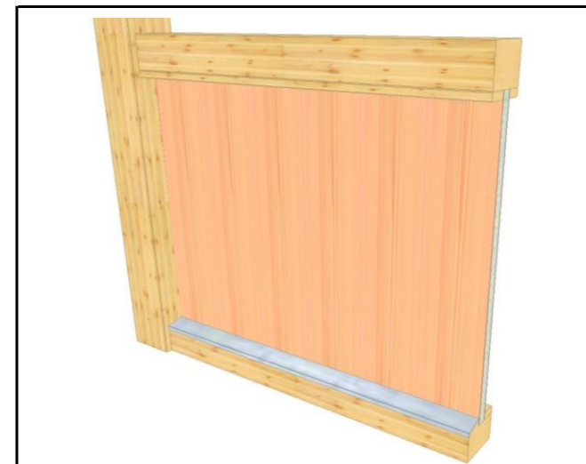
01.1.3 Holz-Sandwich-Platte >> beidseitig verleistet bestehend aus hochwertiger Holzdecklage und hochdämmendem PU-Kern Stärke 30 mm Uw 1,0 W/m²K
