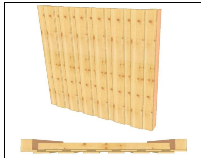
01.1.1 Deckelschalung, senkrecht Unter- u. Deckbrett Fichte 19 x 170 mm >> Sichtqualität, gehobelt Ober- und Untergurt KVH 8 x 12 cm
