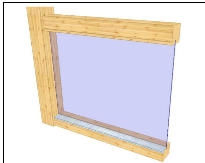
01.1.1 Wandverglasung mit Alu - Tropfkante unten VSG - Verglasung 6 mm
