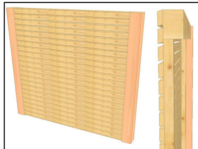
01.1.5 Rhombusschalung, offen zwischen den Stützen montiert sib. Lärche 70 x 21 mm / Lücke 15 mm sib. Lärche 56 x 27 mm / Lücke 15 mm >> Sichtqualität, gehobelt Ober- und Untergurt KVH 8 x 12 cm senkrechte 8 x 8 cm
