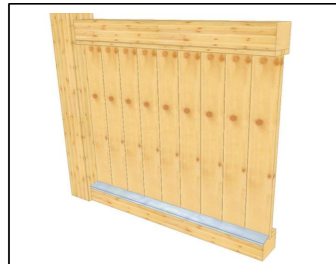
01.1.2 Brüstungsfüllung mit Alu - Tropfkante unten bestehend aus Ober- und Untergurt, Füllung Fichte / Lärche schlicht senkrecht gestäbt Stabbreite 12 cm / ohne Lücke
