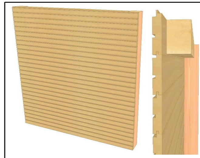
01.1.2 Rhombusschalung, geschlossen vor den Stützen montiert sib. Lärche 27 x 144 mm / Lücke 15 mm >> Sichtqualität, gehobelt Ober- und Untergurt KVH 8 x 12 cm senkrechte 8 x 8 cm
