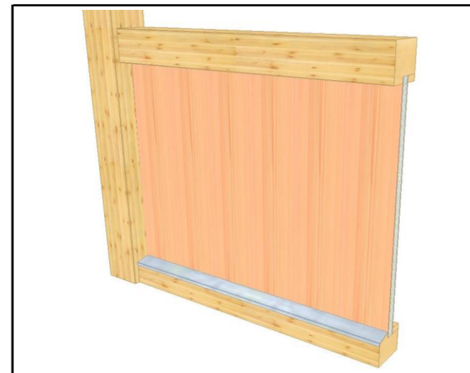
01.2.2 Holz-Sandwich-Platte >> eingefräst bestehend aus hochwertiger Holzdecklage und hochdämmendem PU-Kern Stärke 30 mm Uw 1,0 W/m 2 K
