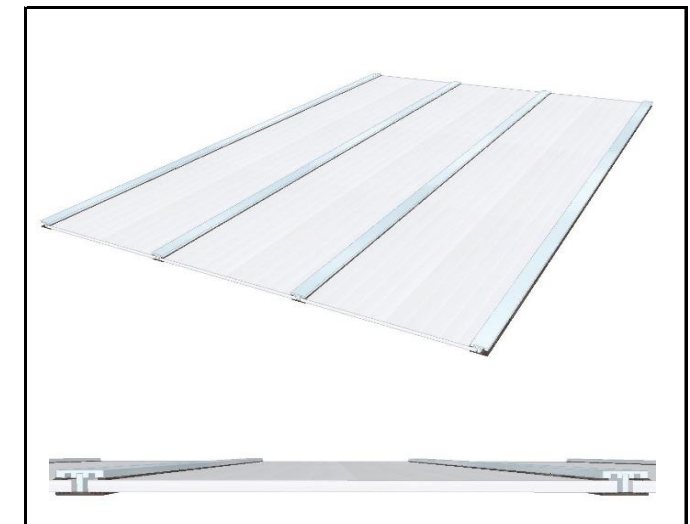
02.3.4 Doppel-Stegplatte 16 mm, HeatStop aus hochwertigem Kunststoff schlagzäh und UV-stabil, hagelfest Farbton: weiß Befestigungssystem aus Aluminiumprofilen Wandanschlussprofil mit Endkappen Pultdach/Satteldach Dachneigung 7%...60°
