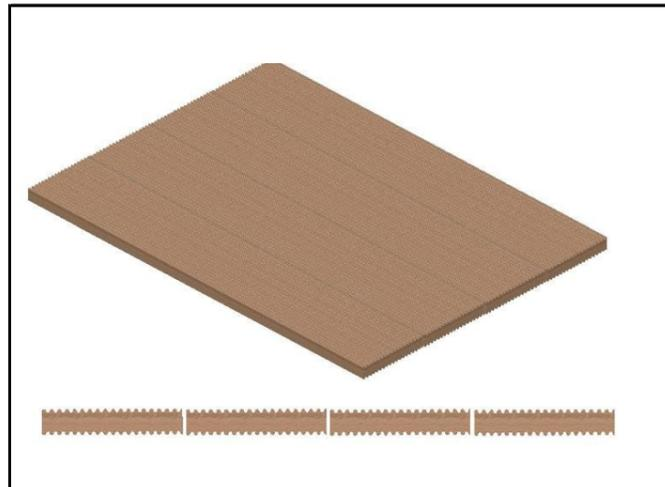
**03.1.1 Fußboden aus sib. Lärche mit Rillenprofil**
