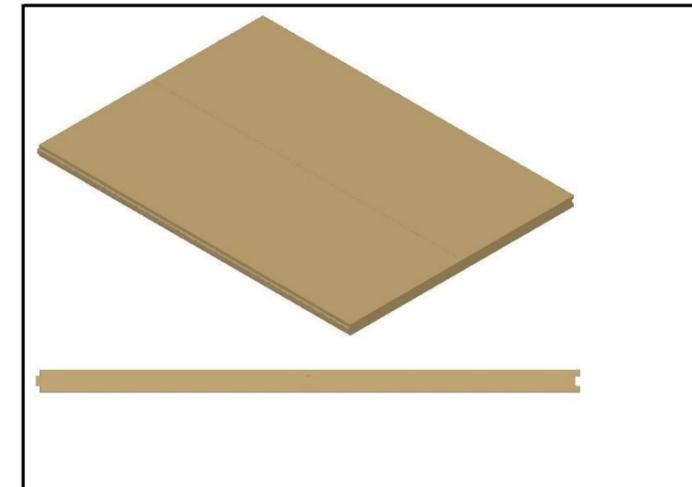
**03.1.3 Fußboden aus OSB-Platte-Nut-Feder**
