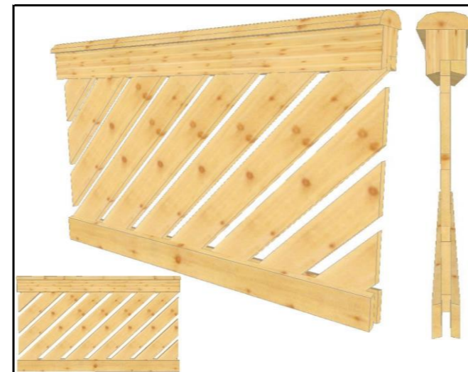
04.1.3 Brüstung mit Handlauf - diagonal bestehend aus Ober- und Untergurt, Füllung schlicht diagonal gestäbt Stabbreite 12 cm / Lücke 4 cm Handlauf gerundet 4,5 x 14 cm
