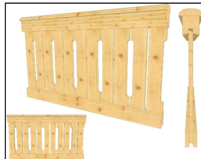
04.1.6 Brüstung mit Handlauf profiliert Typ 3 bestehend aus Ober- und Untergurt, Füllung profiliert senkrecht gestäbt Stabbreite 12 cm Handlauf gerundet 4,5 x 14 cm
