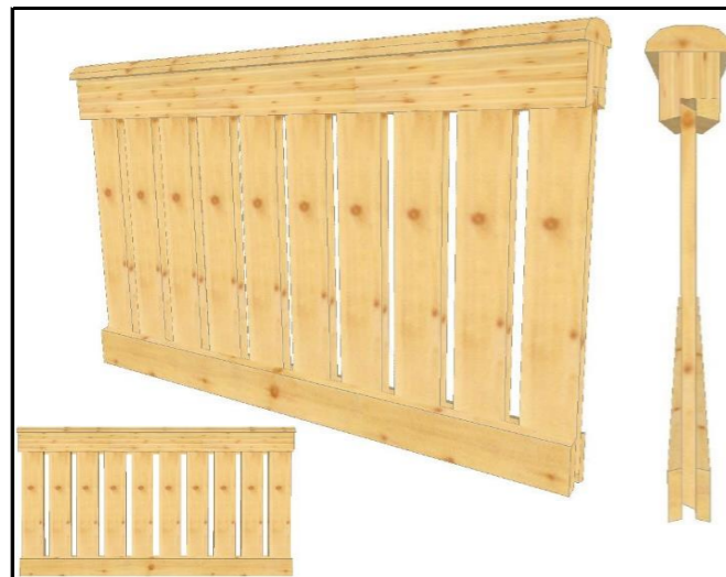
04.1.1 Brüstung mit Handlauf - Standard bestehend aus Ober- und Untergurt, Füllung schlicht senkrecht gestäbt Stabbreite 12 cm / Lücke 4 cm Handlauf gerundet 4,5 x 14 cm
