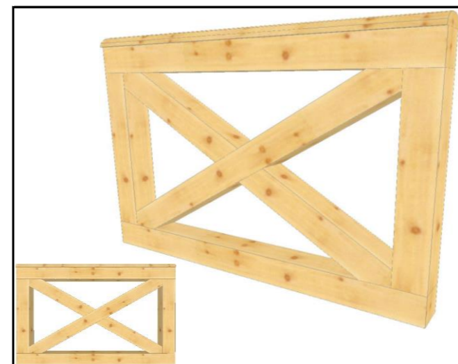
04.1.7 Brüstung mit Handlauf - Andreaskreuz bestehend aus Ober- und Untergurt, Füllung als Andreaskreuz Handlauf gerundet 4,5 x 14 cm
