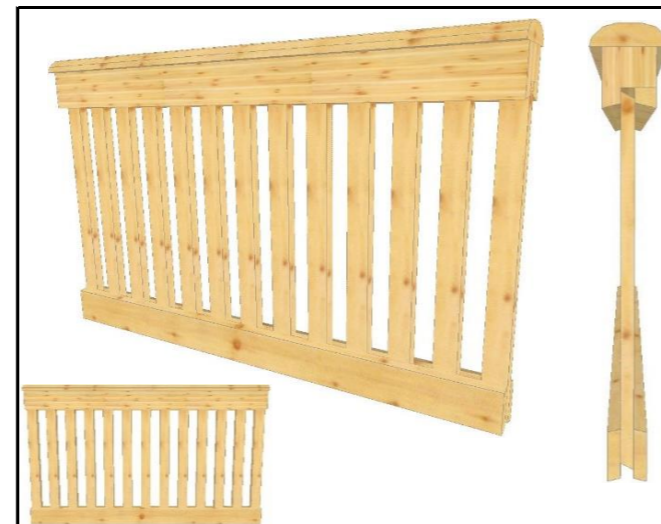
04.1.2 Brüstung mit Handlauf - schmaler Stab bestehend aus Ober- und Untergurt, Füllung schlicht senkrecht gestäbt Stabbreite 6 cm / Lücke 6 cm Handlauf gerundet 4,5 x 14 cm
