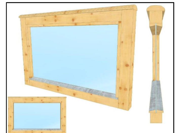
04.1.8 Brüstung mit Handlauf - Glasfüllung bestehend aus Ober- und Untergurt, Füllung aus Verbundsicherheitsglas Handlauf gerundet 4,5 x 14 cm
