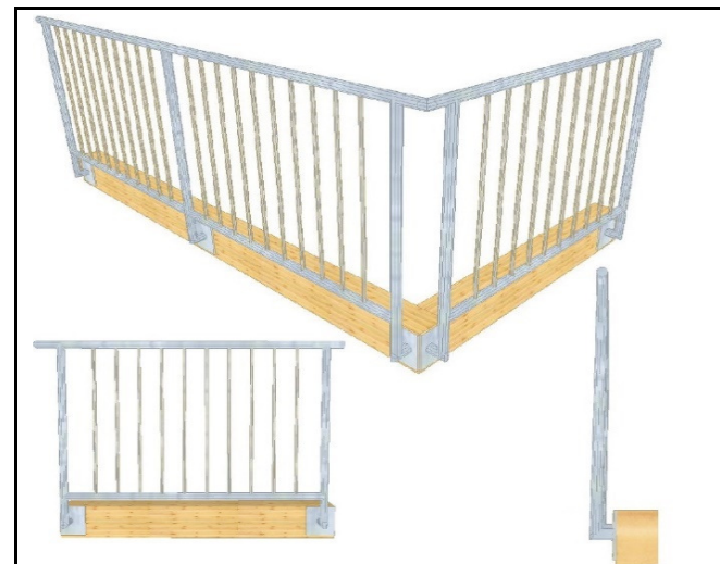
GST 2 Geländer aus Stahl, verzinkt Montage an Träger seitlich angesetzt Ober- und Untergurt rund 42 mm senkrechte Stäbe rund 16 mm Lücke 120 mm
