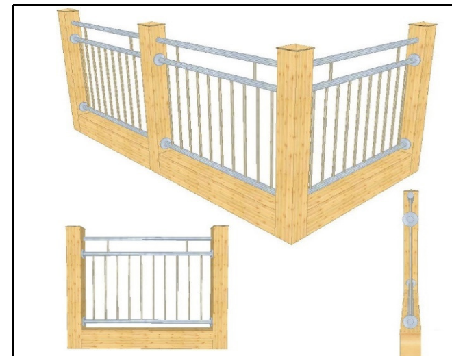
GST 5 Geländer aus Stahl, verzinkt Montage zwischen Stützen Ober- und Untergurt rund 42 mm senkrechte Stäbe rund 16 mm Lücke 120 mm Handlauf Edelstahl rund 42 mm
