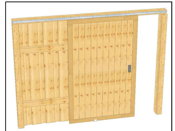
05.1.4 Schiebetür für Geräteraum von 1500 x 2000 mm bis 3000 x 2000 mm
