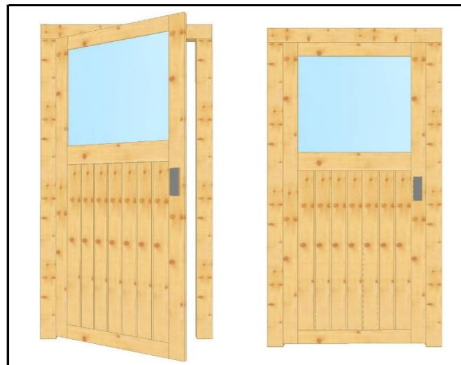
05.1.1 Drehtür für Geräteraum 1-flg. 1000 x 2000 mm
