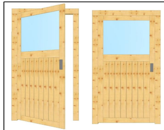
05.1.2 Drehtür für Geräteraum 1-flg. 1100 x 2000 mm
