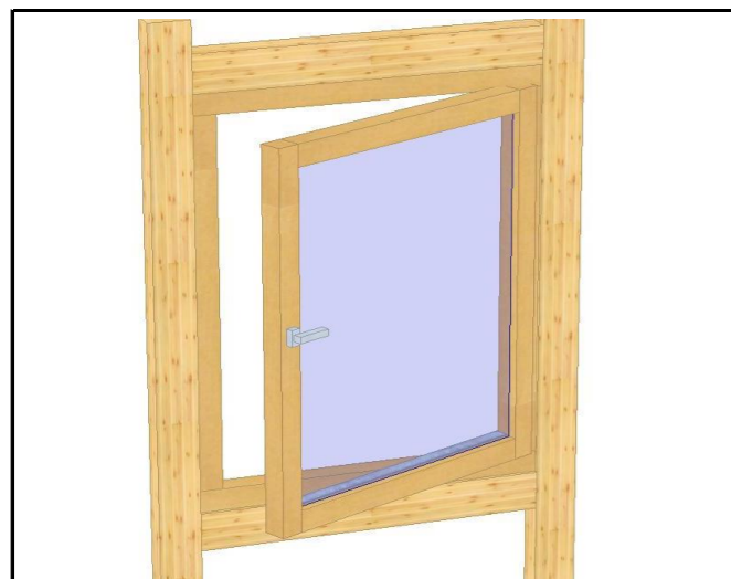
05.2.1 Dreh-Kipp- Fenster 1-flg. ca. 1000 x 1200 mm
