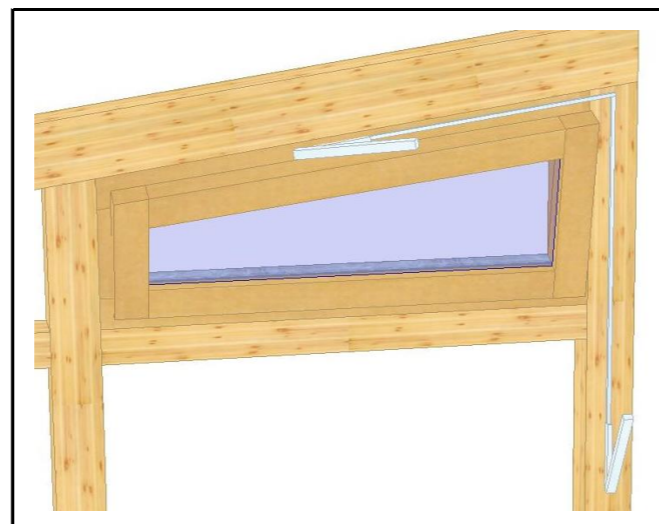
05.2.2 Kipp-Oberlicht 1-flg. Schrägelement mit Handhebelbedienung
