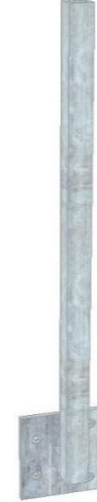
GSF3 Geländer-Stützenfuß Stahl verzinkt, für Montage an Balkonträger Vierkanrohr: 40x40 mm, 900 mm lang Fußplatte: 180mm (hoch) x 160mm (breit)
