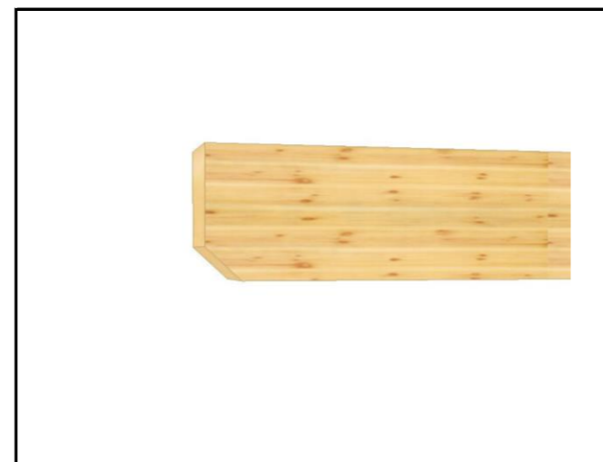
07.1.6 Balkenkopf angeschrägt / Standard
