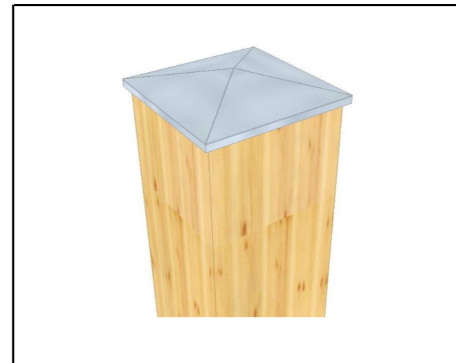
09.1.8 Stützenabdeckung Balkon Edelstahl 150mm verzinkt 170mm
