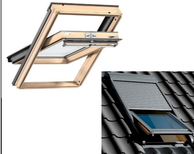
11.1.3 VELUX - Dachfenster GGL Minstdachneigung 15 ° Blendrahmenaußenmaß 780 x 1160 mm Holzart Kiefer natur lackiert außen Aluminium einbrennlackiert grau inkl. Eindeckrahmen und Dampfsperrschürze
